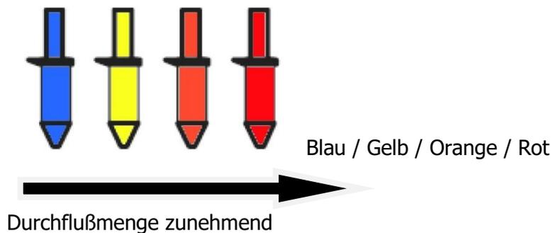
Gemessen werden kann die Durchflußmenge indem man die Düse vom Sprühkopf durch drehen und gleichzeitiges ziehen entfernt, einen Meßbecher unter die Düse stellt und 1 Minute lang die austretende Menge auffängt und anschliessend mißt. Sollte sich die gemessene Durchflußmenge nicht innerhalb eines Bereiches von 60 bis 150 ml/min befinden, muß die Düse ausgetauscht werden.
